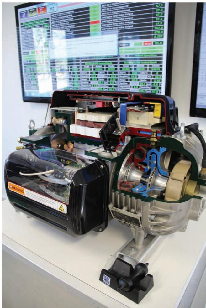
*Compressor Turbocor da Danfoss, eficiência energética*
