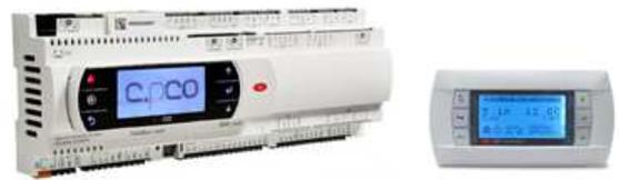
O controle possui protocolo de comunicação Modbus que permite a integração com o Building Management System (BMS) do usuário de monitoramento e controle, e comunicação com supervisor via rede para monitorar e registrar dados de operação do sistema, e emitir relatórios estatísticos que permitem melhorar o gerenciamento.
